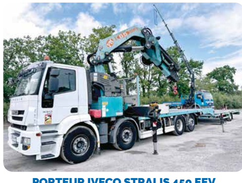
PORTEUR IVECO STRALIS 450 EEV PORTE-MATÉRIEL 8 x 2 ÉQUIPÉ GRUE 65 TONNES + REMORQUE
