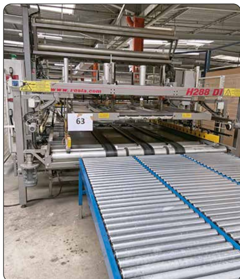
Emballuse de matelas RESTA H288 DI, double emballage automatique, de 2009 + plan 100 kg
