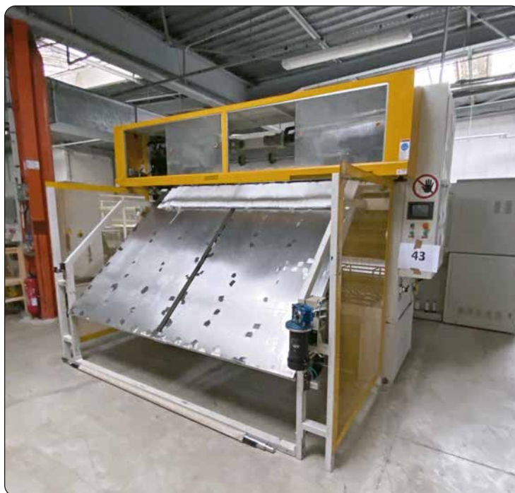
Ligne de fabrication multi-aiguilles SOTEXI (MON TEC) SMANTRONIC, de 2008, 3 dévidoirs
