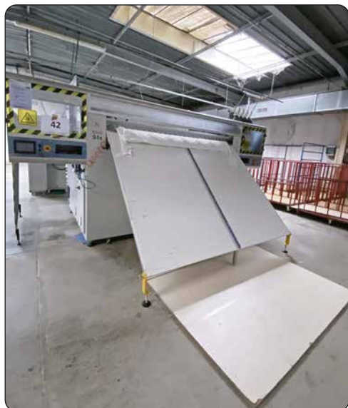
Surjeteuse-coupeuse 4 côtés en finition type LUSYS S4S 2400e, de 2017
