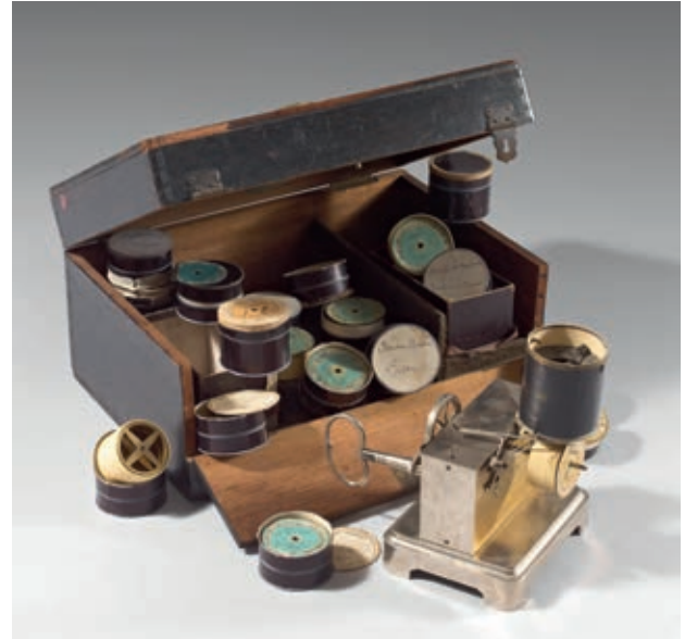
264. Phonographe LIORET n°2, 1985 . Avec 19 cylindres en celluloid de différentes tailles. Volant d'inertie de 6 cm. Résonateur à membranes multiples. Clé papillon. Pavillon en celluloid manquant. Dans son coffret garni de feutre vert. Larg. : 38,5 cm. Haut. : 18,5 cm. Prof. : 26,5 cm.
