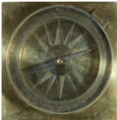
126. **Boussole géodésique** en laiton. Atelier français, vers 1700. Rose gravée de huit rhumbs et couronne marquée septem, oria, midi et oxi, et graduée de 0 à 360°, le 0 au sud. Couvercle sur charnière donnant accès à l'aiguille.
