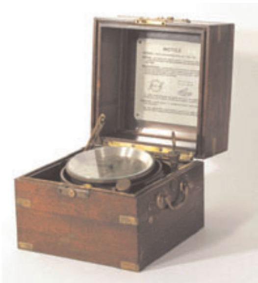
96 - Chronomètre de marine. Présentation traditionnelle avec coffret à deux étages et montre montée à la cardan. Mouvement deux jours (48 heures) à ancre. Signé HAMILTON à Lancaster - USA. Etats Unis d'Amérique. Bon état. Milieu 20ème siècle. 1300/1500 €
