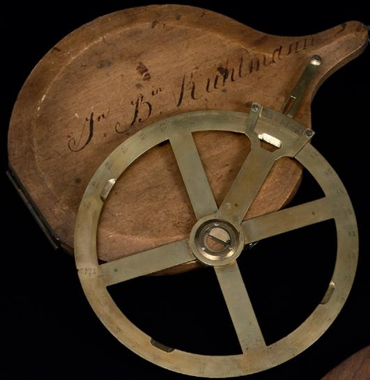
159. **Squadra Mobile ou graphomètre simplifié** d'arpentage en laiton, composé d'un rapporteur et d'une règle montée sur rotule, gradués. Signé CHAROT à Paris. France, vers 1700. 47,3 x 15,2 cm. Dans son étui en noyer. 600/900
