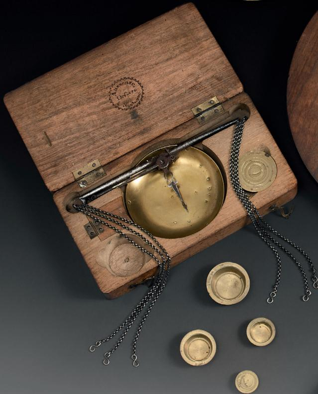
160. **Trébuchet d'orfèvre**, dans son coffret en bois fruitier, l'intérieur évidé de compartiments contenant : un fléau et ses chaînes en acier ; deux plateaux ronds en laiton ; deux piles de poids en bronze ; neuf petits poids en feuille de laiton. Le dos du couvercle portant un cachet d'orfèvre à Narbonne. H. : 4,2 cm. L. : 21 cm. P. : 11,2 cm. 200/300
