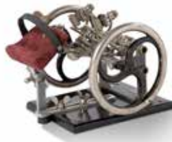
86 Assouplisseur Ochydactyl de Georges RETIF modèle à roue, en acier et caoutchouc sur plaque en tôle laquée noir. Appareil permettant d'augmenter la souplesse et la force des doigts des musiciens. Plaque du fabricant « Ochydactyl / Breveté SGDG en France et à l'étranger / Sancoins (Cher) ».
