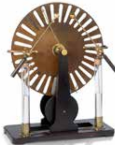
38 Machine électrostatique de WIMSHURST en bois noirci, verre et laiton, les disques en ébo- nite, avec éclateurs et manivelle. Fin du XIX e - début du XX e siècle 61 x 48,5 x 24,5 cm 200 - 300 €
