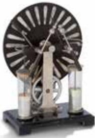
37 Petite machine électrostatique de WIMSHURST en bois noirci, verre et métal, les disques en ébo- nite, avec éclateurs et manivelle. Fin du XIX e - début du XX e siècle 26 x 17 x 11 cm 80 - 120 €
