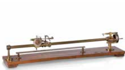
88 STUTZ & Cie à LILLE Dynamomètre sérimètre horizontal ou détorsionneur de fils de soie, en laiton et métal sur socle en bois, plaque du fabricant, n° 1005. L. 90 cm
