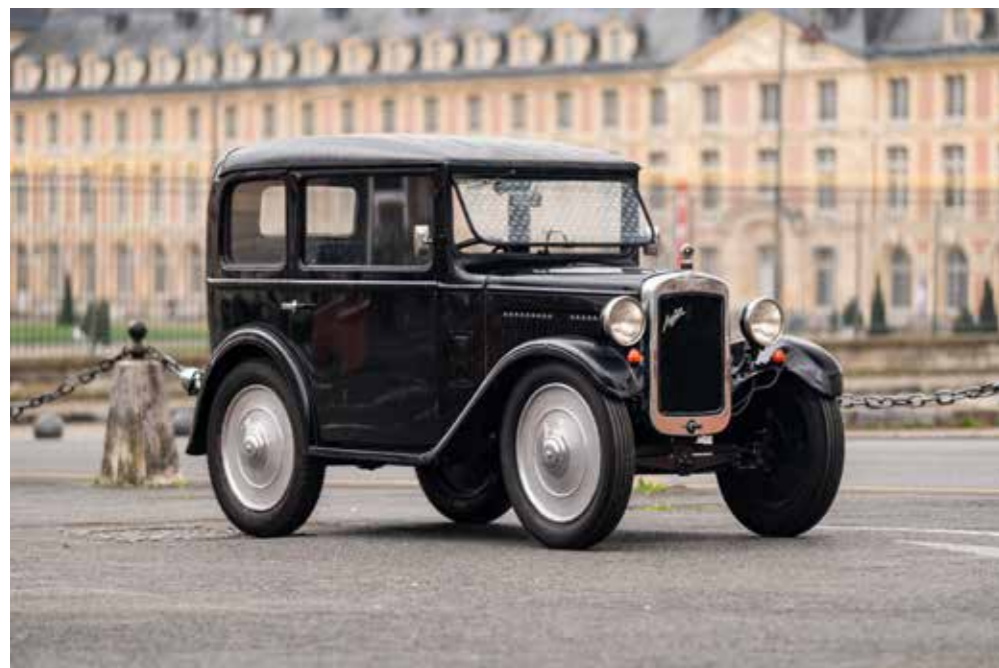
S'agissant d'une RM, cette petite voiture a été produite avec un châssis court et les lignes de porte s'étendent donc autour des passages de roue arrière pour permettre un accès facile.
