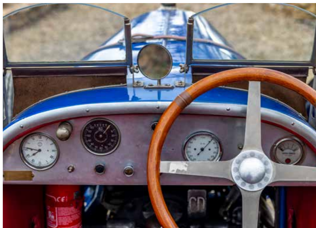
Le tableau de bord contient les essentiels : compte-tour, vitesse, une montre et la pression d'huile.
