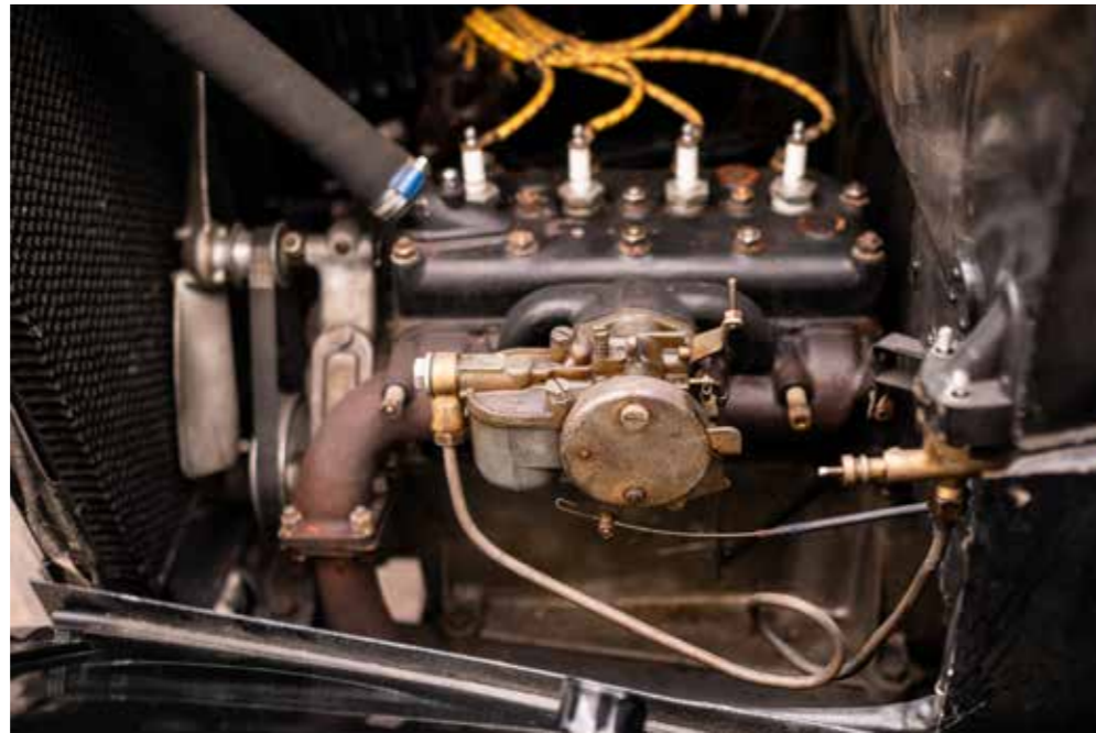
↑ Notre vaillant 4 cylindres en ligne (56 x 76 mm) pour 748 cm3 dont la réputation de fiabilité n'est plus à faire.
