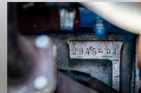
Les frappes moteurs sont bien concordantes, le vaillant Ruby DS n'attend qu'une chose, retrouver un compresseur Cozette numéro 7.
