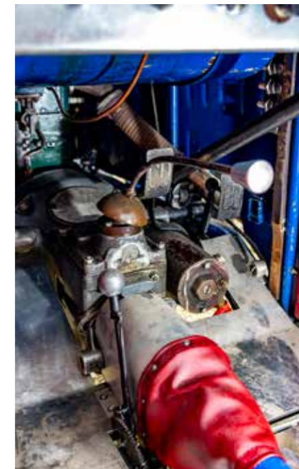
L'ensemble boîte de vitesse et pédalier. La pédale d'embrayage a été modifiée pour l'installation d'un démarreur.
