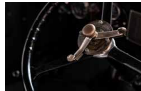
Sur le volant, en position centrale, réglage d'avance et accélérateur à main.
