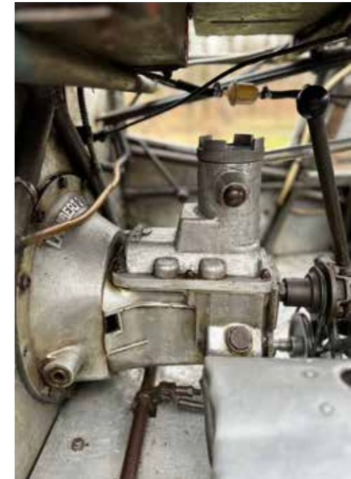
Le pont comme la boîte de vitesses sont de conception Lambert, on y retrouve bien l'inspiration de ses maîtres Bugatti et Voisin, ce qui est performant est beau !
