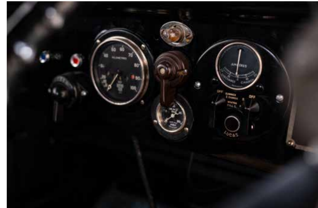
Ampèremètre, pression d'huile et compteur de vitesse, le tableau de bord est très complet pour une voiture dite populaire.
