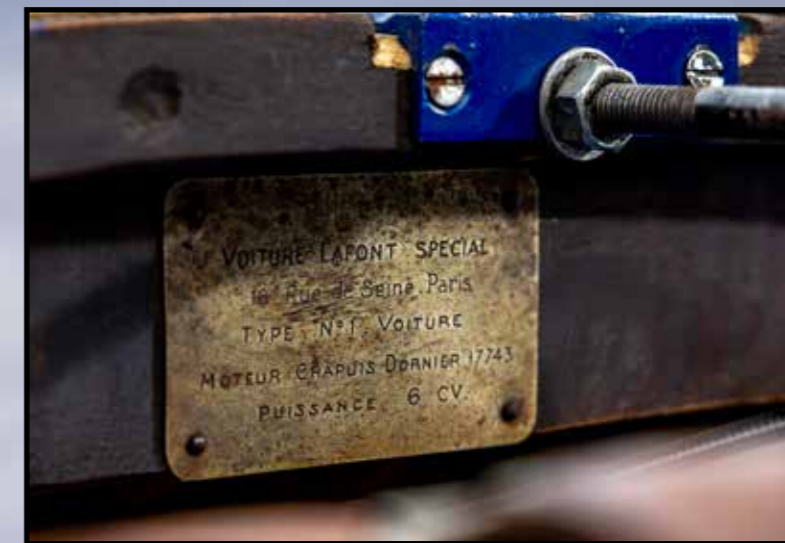
La plaque châssis précise l'adresse du constructeur, le numéro de châssis et un numéro de moteur Chapuis-Dornier qui ne correspond pas à celui en place. Peut-être s'agit-il du numéro du 12 soupapes initialement installé!
