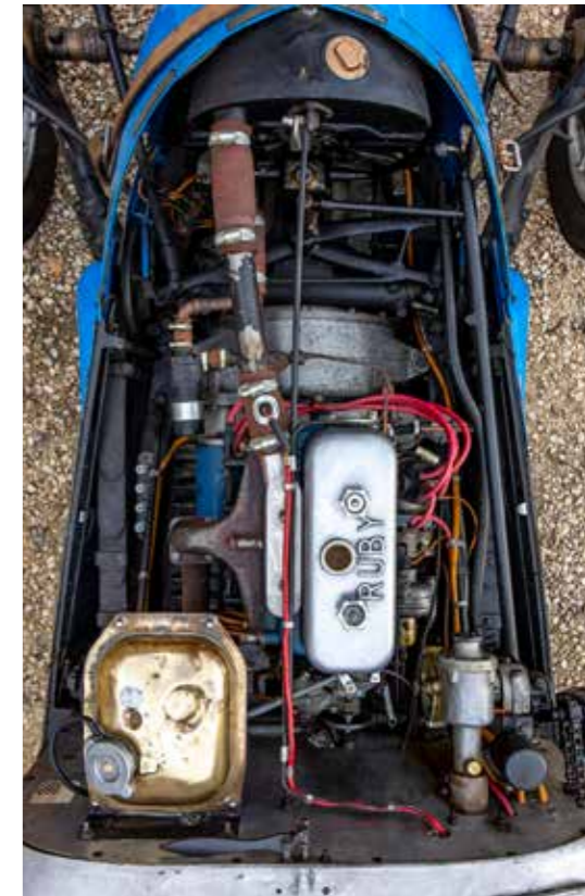
On comprend bien l'ensemble pont avant boîte moteur posé sur le châssis quadrangulaire.
