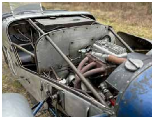
Tout pour la légèreté. Germain Lambert l'avait bien compris, le Lambert/Ruby ne serait pas suffisant pour gagner des courses. Châssis tubulaire, carrosserie aluminium et pièces de bois et d'acier évidés permettaient d'obtenir une voiture extrêmement légère, maniable et vive malgré sa petite cylindrée.
