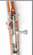
Fusil d'essai PELEUNI et CLERET à AVRANCHES transf. à percussion puis à culasse | BIS.
