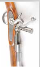
Fusil d'essai garniture laiton, chargement culasse, levier escamotable.
