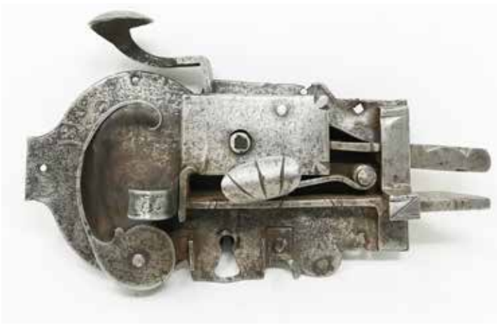
193. Serrure à deux pènes, l'un à clé l'autre clenche 14,8 x 25,7 x 9,5 cm
