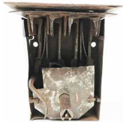
105/1. Serrure de coffre et sa gâche à quatre arceaux canon pour clé forée en tiers point. Secret d'ouverture : la clé semi-sortie actionne par le levier à gauche les deux derniers pènes. 17 x 13, 63 cm
