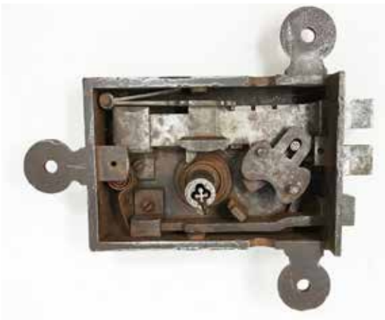
105. Serrure à pêne dormant fourchu, pêne demi-tour et commande de pènes haut et bas. 17, 1 x 19, 7 cm
