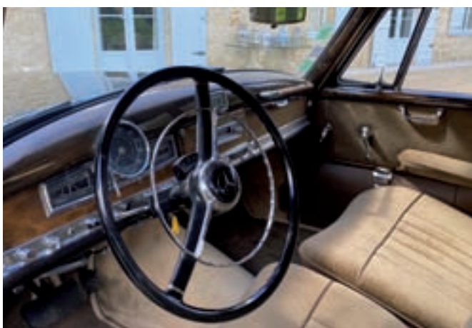
13 MERCEDES BENZ 300 C Limousine découvrable « Adénauer » 4 portes, noire du 15/09/1956, carte grise française de collection, n° de série 1860176500062, type W186, 45508 km au compteur. Moteur 3 litres, 6 cylindres en ligne alimenté par 2 carburateurs, 17 CV fiscaux, boîte de vitesses automatique. Sellerie velours et simili beige. Tableau de bord et entourages intérieurs des vitres en bois vernis, bien complet de ses instruments de contrôle, volant d'origine avec cerclé de Klaxon. Automobiles ayant appartenu pour la plupart à des chefs d'état ou au show-biz. En état de marche. 50 000/70 000 €
