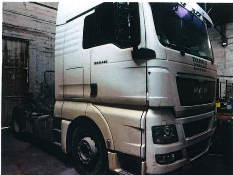
**Observations :** Véhicule non roulant, boîte de vitesse démontée, Injecteurs hors service.
