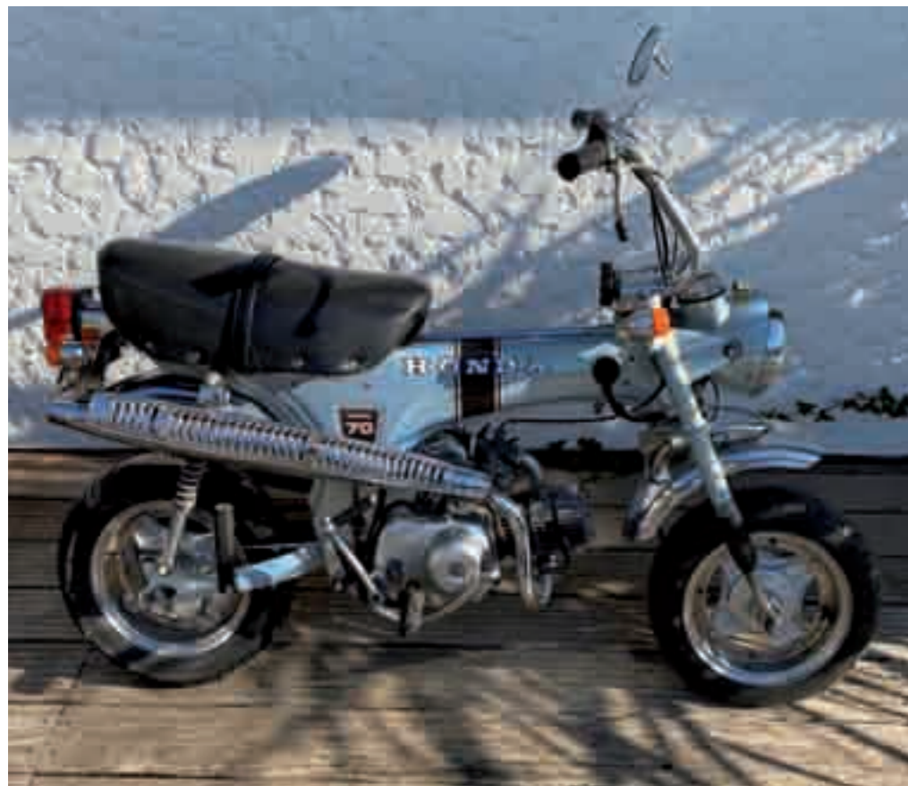
9 HONDA Type ST 70 DAX vélomoteur MTL gris bleu et chromes, 2 places du 08/05/1974 n° de série 557789, mono 4 temps 1 ACT, 72 cc 1CV, 5,6HP à 9000 Tr/mn. Carbu keihin 13 mm. Embayage auto. 4 vitesses sélecteur au pied, freins à tambour. 29801 kms au compteur. Carte grise française. 1500/2 000 €
