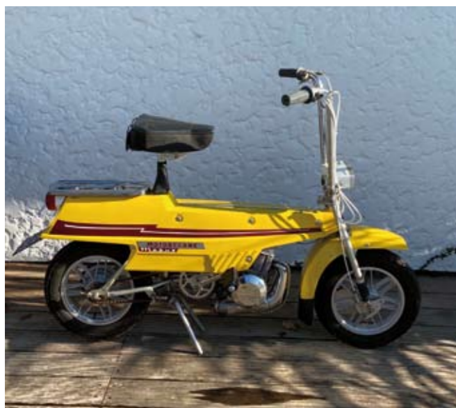
25 MOTOBECANE Mobyx Type X7 cyclomoteur CL jaune, 1 place du 01/10/1973 n° de série 07003073, mono 2 temps Isodyne 49,9 cc. variateur Mobyomatic, freins à tambour. Carte grise française. 1 000/1 200 €
