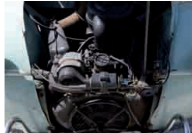
2 CITROËN 2CV6 Berline découvrable 4 places, 2CV6 type AZKA du 30/10/1981, n° de série VF7AZKA 0077KA8826, 3 CV fiscaux de couleur vert clair, sellerie simili noir d'origine, capote noire. Moteur 2 cylindres à plat de 602 cm 3 . Boite de vitesses mécanique à 4 rapports. Jantes acier. Compteur annonçant 13563 kms. Carte grise française + contrôle technique défavorable. Notice d'emploi et factures depuis 2012. Moteur en état de marche. 2 000/3 000 €
