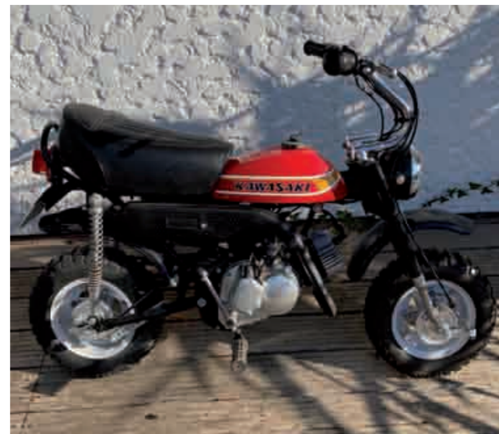
16 KAWASAKI Type KV 75 vélomoteur MTL noir et rouge, 1 place du 01/01/1973 n° de série 38384, Mono 2 temps 73 cc 1 CV. Boite mécanique sélecteur au pied, freins à tambour. Carte grise française. 3 500/4 000 €
