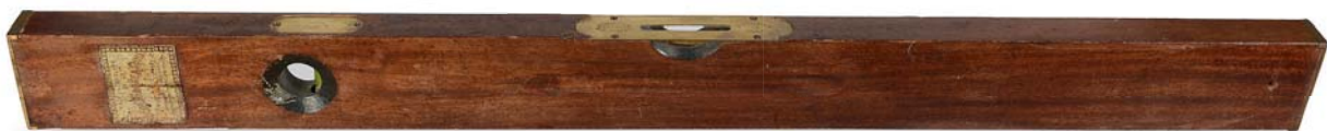
391 - Niveau de charpentier de marine en acajou et laiton brossé. John Rabone & Sons - Birmingham Angleterre vers 1900. H. 91 cm - L. 8 cm - P. 3 cm
