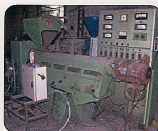
Machine, extrudeuse de plastique ANDOUART, moteur à décalage de balais, diamètre vis : 90, longueur vis : 25 D, 1971
