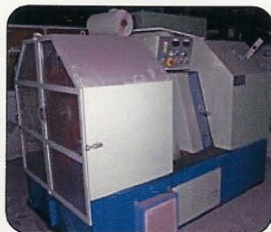
Guipeuse CMG, 12 bobines par plateau, 750 tours/minute, 1997
