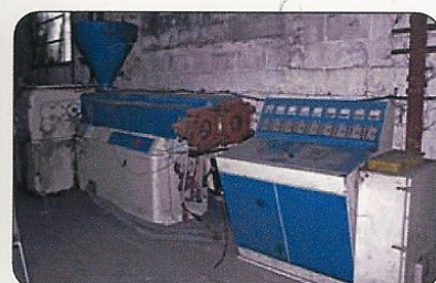
Machine, extrudeuse de plastique COVEMA, moteur asynchrone 45 kW, diamètre vis : 100, longueur vis : 25 D, 1980
