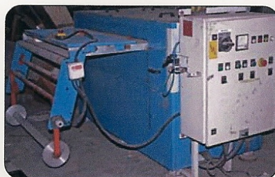
Broyeur à film MECCANOPLASTICA, largeur entrée : 1,2 m, 15 kW, 1998
