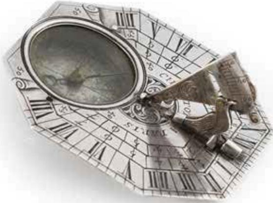
**317. Cadran solaire de poche** de type Butterfield en argent. La platine octogonale gravée des échelles horaires pour les latitudes 40°, 45° et 50° ; axe triangulaire , l'index en forme d'oiseau; le dos gravé des noms et des latitudes de grandes villes françaises et européennes; le revers de la boussole à décor d'une rosace de feuilles d'acanthe.
